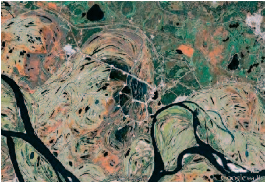
Рис. 6.9. Размытые во время половодья песчаные насыпи коридоров коммуникаций Северо-Покурского месторождения нефти (фрагмент космического снимка Landsat 2002 г., геосервис Google Earth)
