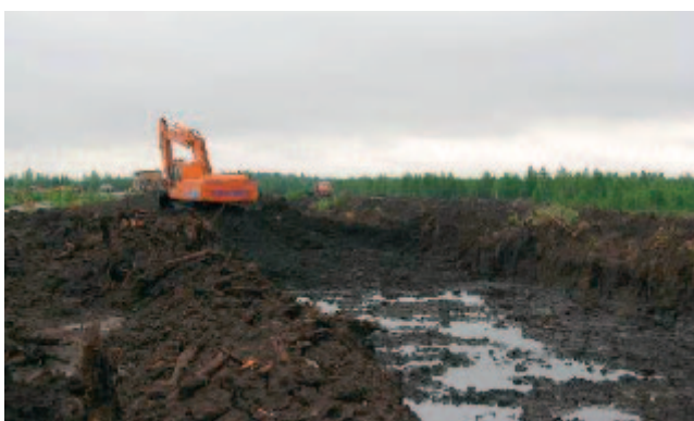
Рис. 7.24. Экскаваторный способ добычи торфа в пригороде г. Сургута, ХМАО (фото Е.С. Воистиновой, 2011)
